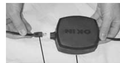
Connecteur 2 broches du cordon du transformateur Transformateur électrique
