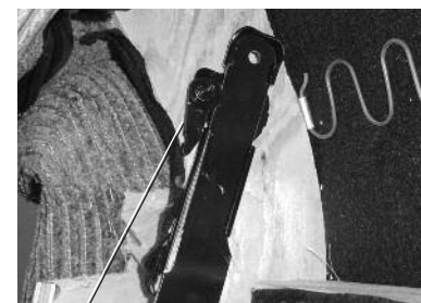
Levier de blocage en position « bloqué »
