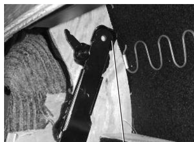
Fixations du dossier et de la charpente engagés
