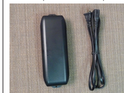
Transformateur d'alimentation Connexion cordon d'alimentation de 120 V
