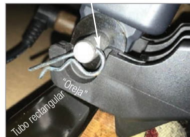
La flecha muestra el tope de la "oreja" en el conector del motor
