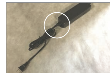
Brancher le cordon d'alimentation au transformateur électrique
