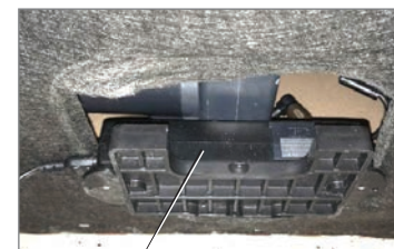
Placer le transformateur électrique sur l'étagère
