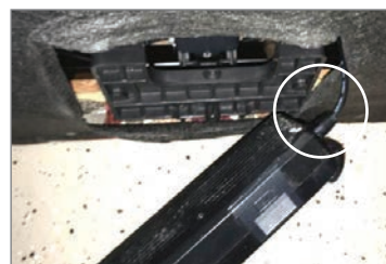
Conecte el conector del motor directamente a la fuente de alimentación para las unidades modulares y sillones
