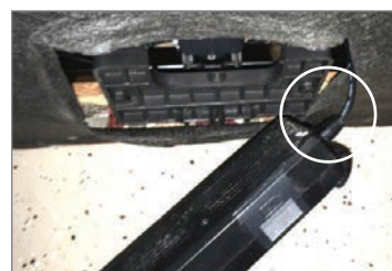
Brancher le connecteur du moteur directement au transformateur électrique pour les modèles de types modulaires et fauteuils
