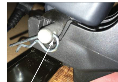
La flecha muestra el conector del motor ubicado COMPLETAMENTE hacia la parte trasera de la "oreja"
