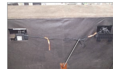
Enrouler et attacher le câble Y en excès avec le collier de serrage (s'applique aux canapés et aux causeuses)
