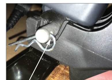
La flèche indique que le pignon du moteur est tout au fond à l'arrière de l'« oreille »
